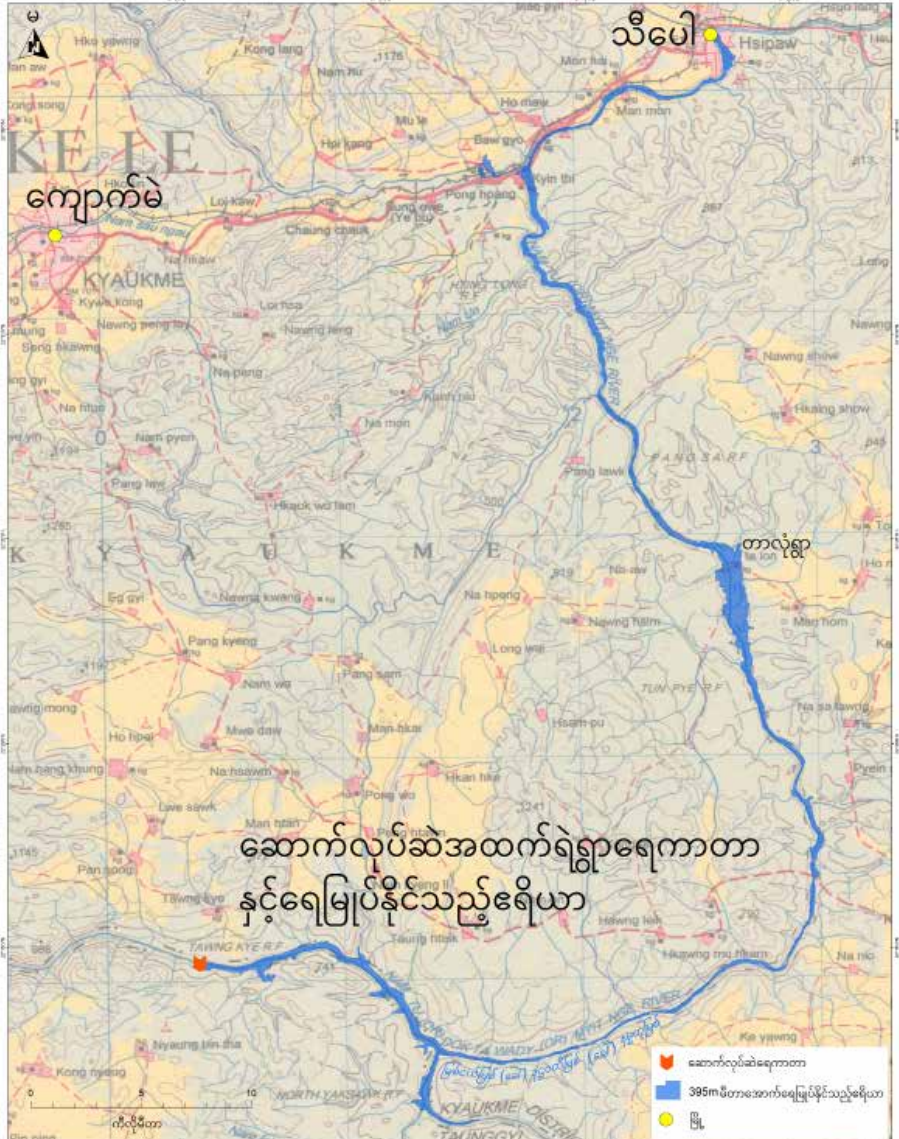
ရေလှောင်ကန် ပင်လယ်ရေ မျက်နှာပြင် ၃၉၅ မီတာ နှင့် အထက်ရဲရွာရေကာတာစီမံကိန်း၏ရေမြုပ်နိုင်မှုဇုန်
